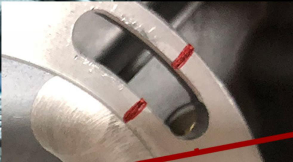
Jetzt den Keil vom KW-Stumpf entfernen (falls nicht schon geschehen und das Polrad so aufstecken, dass der Strich auf dem Polrad auf die rote Markierung der Grundplatte zeigt
