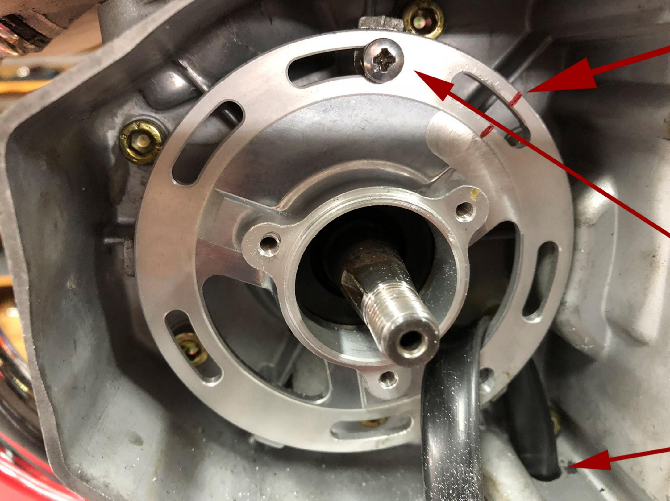
Die rote Markierung der Grundplatte sollte irgendwo ungefähr in dem rechten oberen Bereich sein, weil dann der Kabelstrang der aus der Zündung kommt am saubersten nach unten aus dem Gehäuse läuft ohne dass er irgendwo am Motorgehäuse eingeklemmt werden kann. In der Einbauanleitung steht, dass die rote Markierung am Gehäuse ausgerichtet werden soll, dass müssen wir nicht beachten weil wir später die Keilnut im Polrad haben.
